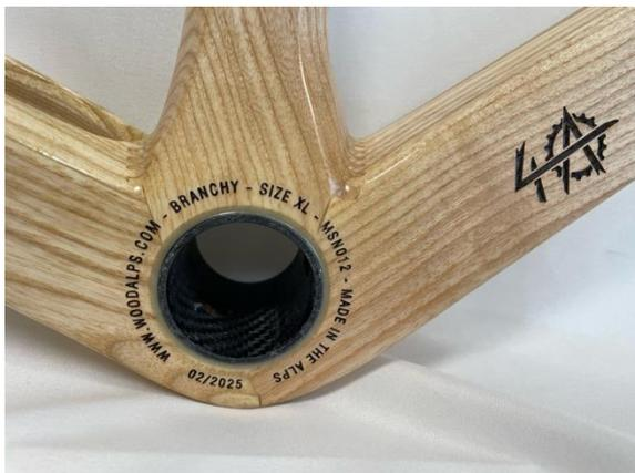
Des adaptateurs permettent de monter la plupart des pédaaliers, Shimano, Sram, ou autre
