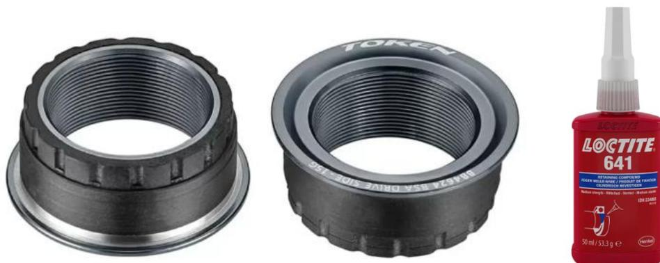
Bien qu'il n'y ai généralement pas de problèmes, il est recommandé d'utiliser du produit de fixation LOCTITE 641 entre l'adaptateur et l'insert carbone afin de s'assurer de l'absence de micromouvements pouvant générer un bruit.
